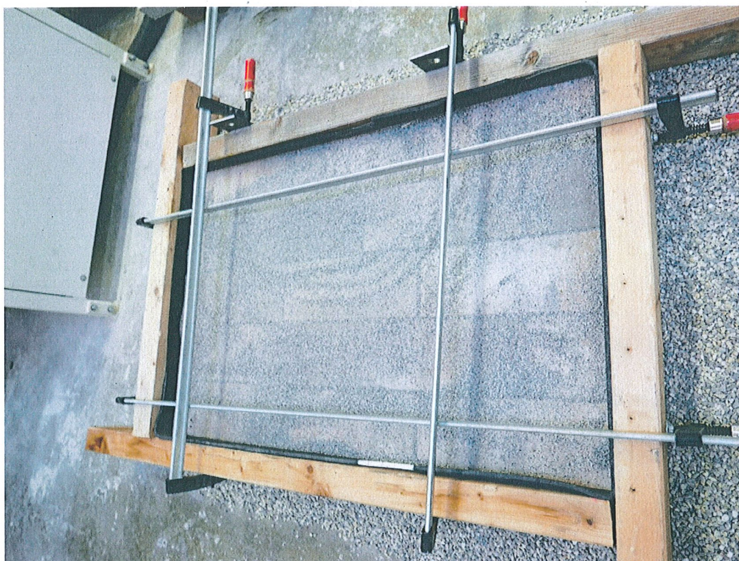
Bild 4: Vorbereitetes Versuchsfeld für die Bestimmung der Versickerungsfähigkeit
