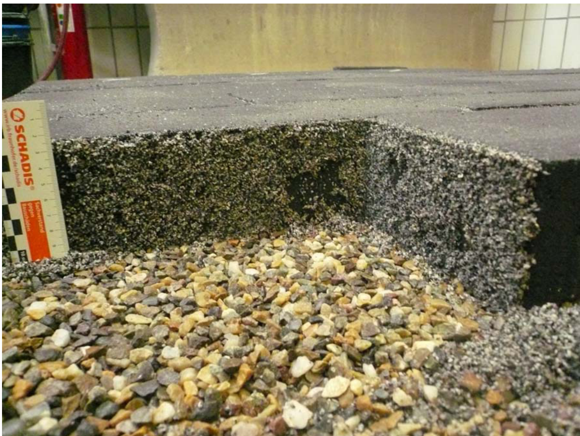
Bild 6: Detailansicht, Fuge nach Bewässerung
