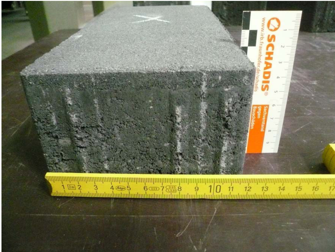
Bild 1: Betonpflastersystem „Trecaro“, Seitenansicht Pflasterstein, Steinhöhe 80 mm, mit ausgebildeten Abstandshaltern
