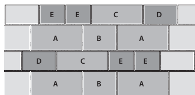
Exemple de pose avec changement des pavés (E et D sont interchangeables).
