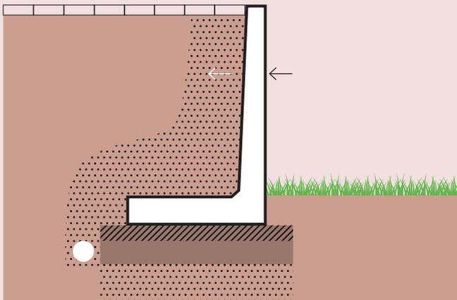
Beim Einbau ist darauf zu achten, dass die Stützwandelemente auf der Sichtseite mindestens um die Fussdicke unter der Geländeoberkante eingebunden werden.
