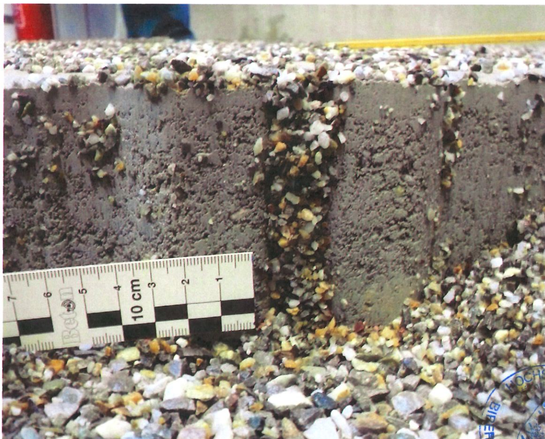
Bild 7: Detailansicht, Fuge nach Bewässerung
