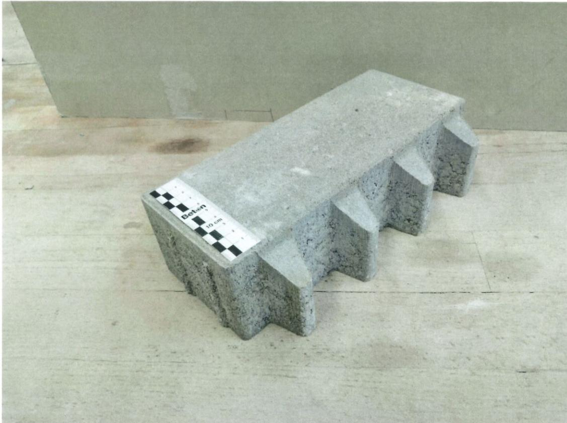
Bild 1: Betonpflastersystem „Unico verde“, Seitenansicht Pflasterstein, Steinhöhe 80 mm, mit ausgebildeten Abstandshaltern
