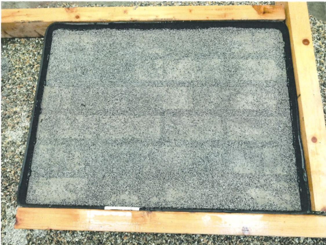
Bild 3: Versuchsfeld - Fugenbreite wurde mit 30 mm eingestellt
